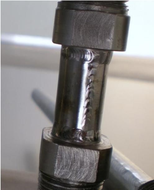
L'elio, l'argon o una miscela dei due gas genera un'atmosfera che impedisce l'infragilimento da assorbimento di ossigeno, di azoto o di idrogeno nel metallo riscaldato.
