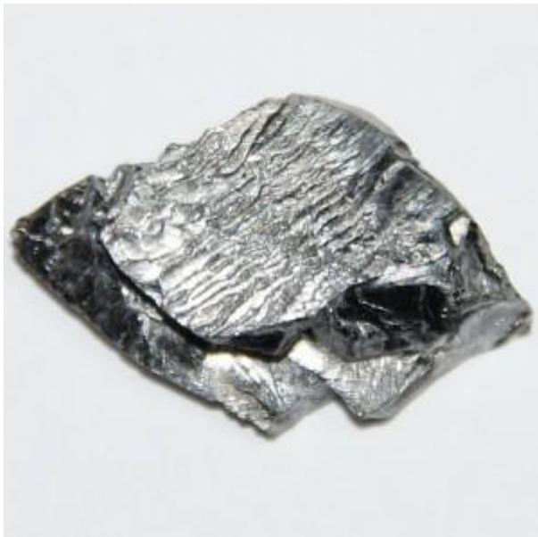
struttura basilare del metallo duro a partire dalla quale altri tipi di metalli duri sono stati sviluppati. In aggiunta al primo carburo di tungsteno – di composizione cobaltica- il metallo duro può contenere svariate proporzioni di carburo di titanio(TiC), carburo di tantalio(TaC), e carburo di niobio(NbC).
