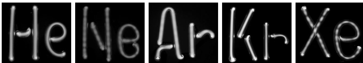
Figura 29. Tubi a scarica contenenti i vari gas nobili e sagomati nella forma del simbolo dell'elemento che contengono. Le diverse luci colorate che si osservano sono dovute allo spettro di emissione atomica dei rispettivi elementi quando vengono sottoposti ad una corrente elettrica.
