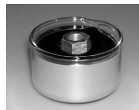
Figura 12. Bullone in ferro che galleggia sul mercurio.
