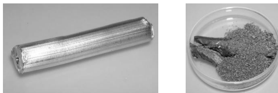
Figura 20. A sinistra campione di stagno bianco. A destra campione di stagno grigio.
