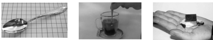
Figura 15. A sinistra, cucchiaino di gallio realizzato tramite stampo nei nostri laboratori. Al centro, cucchiaino di gallio che fonde mentre si mescola un tè caldo. A destra, cubetto di gallio che fonde grazie al calore corporeo.
