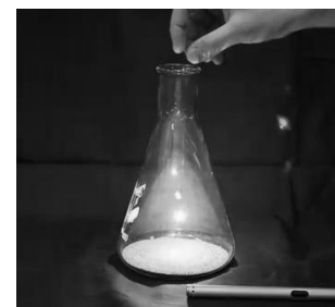
Figura 27. Fotogramma del filmato di combustione del fil di ferro in una beuta saturata di ossigeno.
